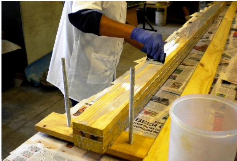
Figura 10: Aplicación de Sikadur 301™
