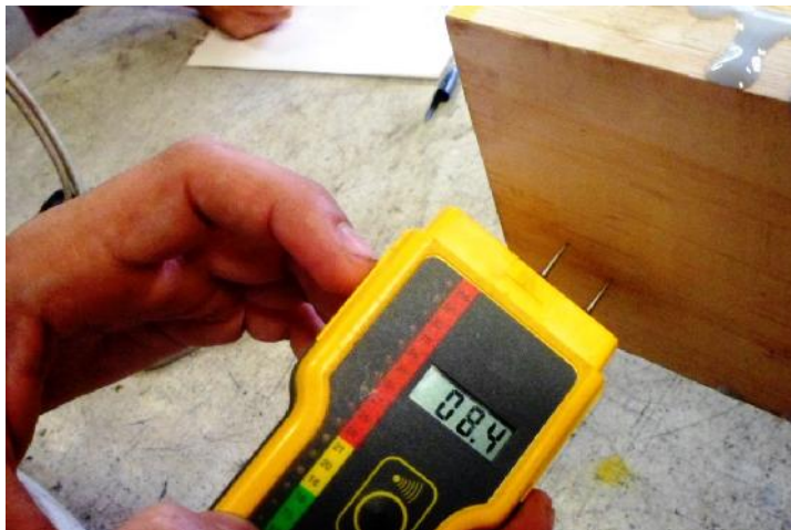
Figura 7: Análisis de humedad de las planchas de madera
