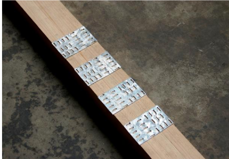
Figura 17: Viga de madera laminada Glulam reforzada con pletinas metálicas dentadas
