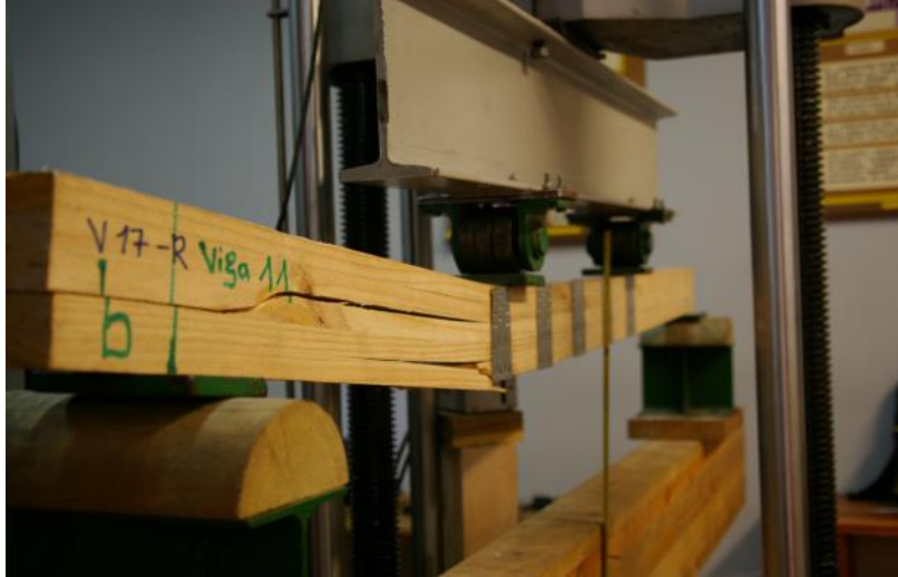
Figura 19: Ensayo de flexión de cuatro puntos
