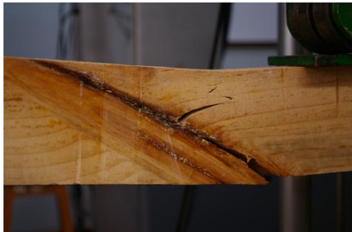
Figura 36: Ruptura de viga de madera maciza en zona con alteraciones físicas
