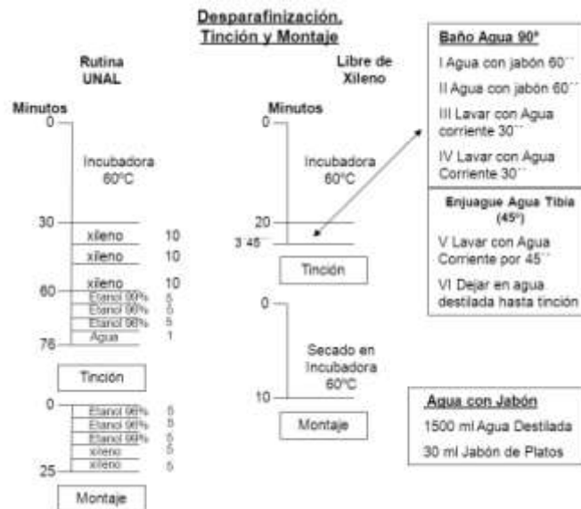
Ilustración 5-3: Proceso de desparafinización y coloración implementado
