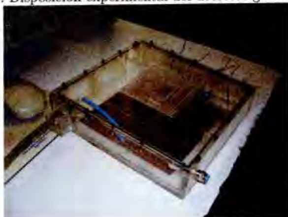
Figura 2.3: Disposición experimental del detector gaseoso pixelado
