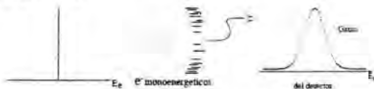
Figura 1.4: Función respuesta cuando inciden electrones monoenergéticos sobre un detector grueso[11]
