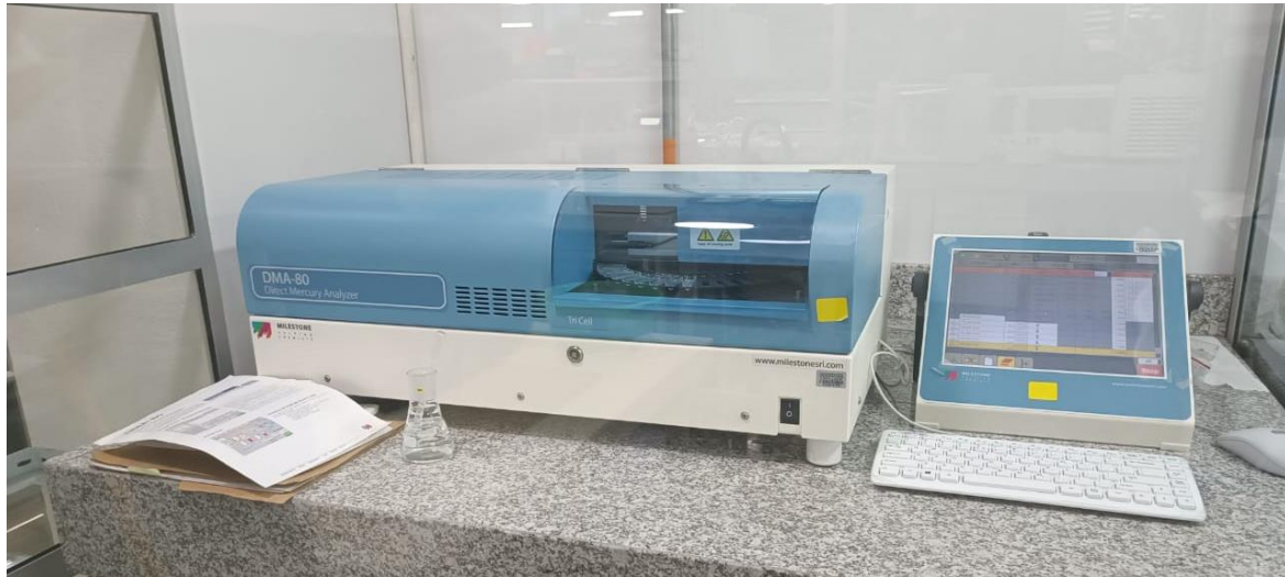
Figura 13. Analizador directo de Mercurio DMA-80
