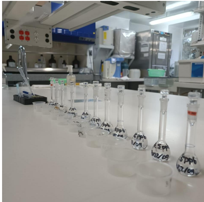
Figura 12. Muestras de mercurio a diferentes concentraciones para la lectura de la Absorbancia, Laboratorio de la Corporación Universitaria Lasallista de Colombia, Antioquia.
