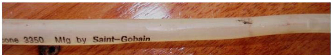
Figura 43. Desgaste en las mangueras conductoras de medio, evidenciado en los cambios de diámetro de las mismas, ocasionado por las bombas peristálticas empleadas en el sistema de biorreacción adoptado para el cultivo de raíces de Brugmansia candida .
