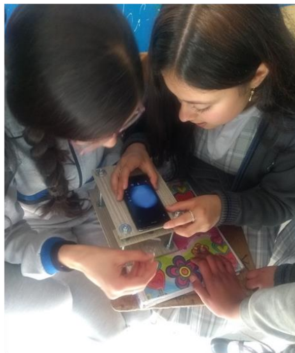
ANEXO 2F. Elaboración de montaje en madera para adaptar el smartphone como microscopio casero y primeras fotos de tejido y letra de papel periódico tomadas por los estudiantes.
