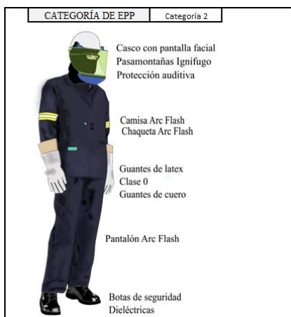
Figura 30 (a) EPP con la norma NFPA 70E.
