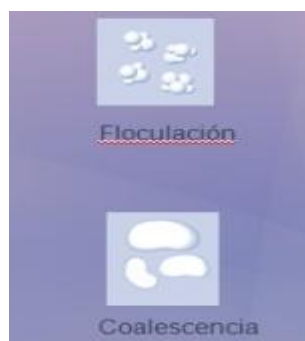
Figura 3.4 Floculación y coalescencia en una emulsión Tomado de http://www.iesmat.com/Productos-FO-EES-MA2000.htm
