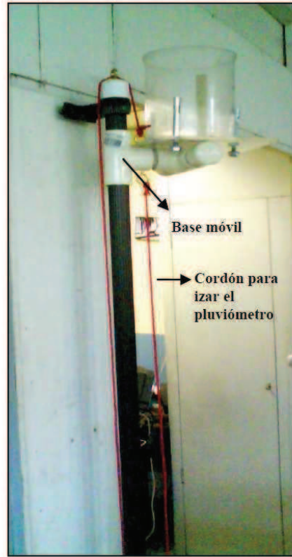
Imagen 11. Pluviómetro izable construido por el Grupo Base UN (tomado de la guía para el taller de construcción del instrumento).
