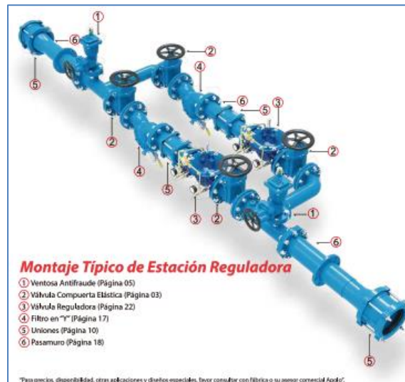
Ilustración 7: Montaje típico de estación de regulación (APOLO, 2019)
