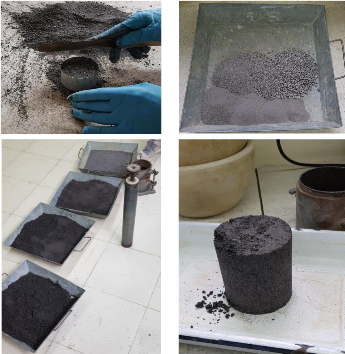
Figura 27.- Preparación de la muestra de ceniza volante y escoria en el laboratorio.
