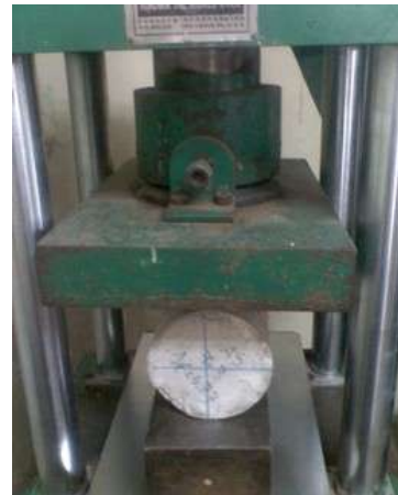
Figura 4.50. Ensayo de Tensión Indirecta de Concreto Liviano con ALISUR.
