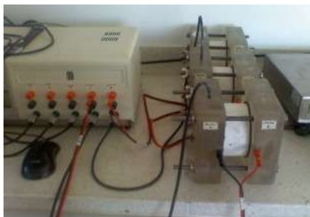
Figura C.4. Montaje del ensayo de penetración al ión cloruro.
