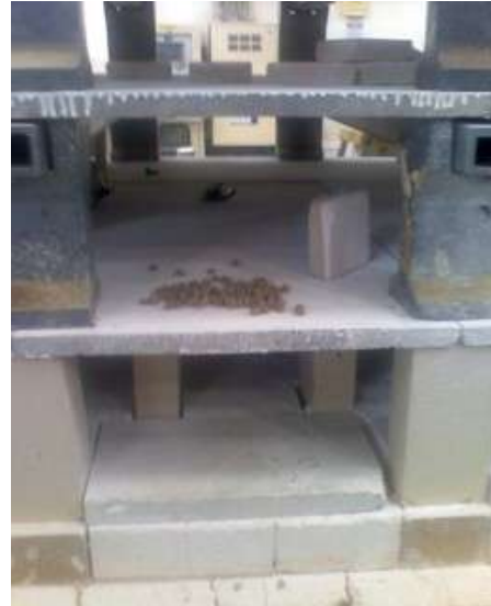
Figura 4.41. Colocación del agregado en el horno estático.
