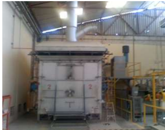
Figura 4.43. Quemado del material a 1300^{\circ}\text{C} .
