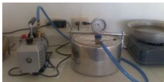
Figura C.2. Olla de despresurización.
