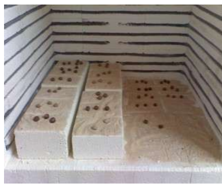
Figura 4.13. Muestras de arcilla del sur de Bogotá, al ser sometidas a quema rápida.
