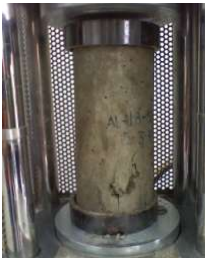
Figura 5.13. Falla típica a compresión de
