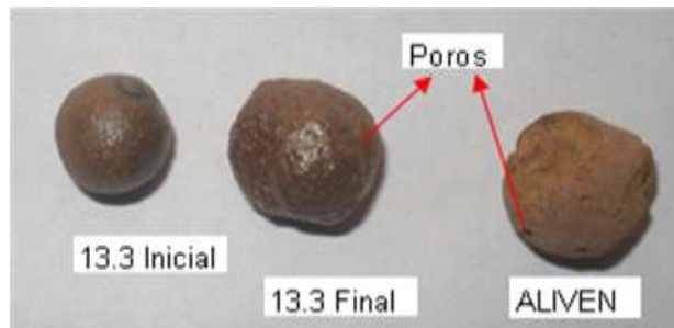
Figura 5.3. Comparación de la arcilla de referencia 13.3 antes y después de la quema con ALIVEN.
