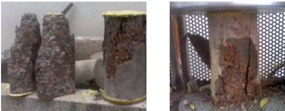
Figura D.2. Modo de falla a los 28 y 56 días del Concreto Liviano de Alta Resistencia.
