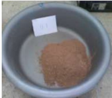
Figura 4.9. Arcilla de referencia 11.1 molida pasa tamiz 100.
