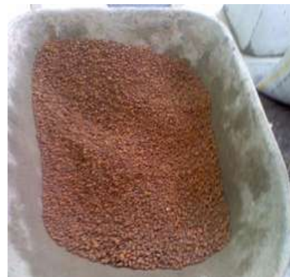
Figura 4.46. Material de granulometría fina ya tamizado, después de haberle eliminado los finos.
