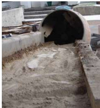
Figura 4.35. Pellets de arcilla introducidas en una mezcladora para darle una forma redondeada.
