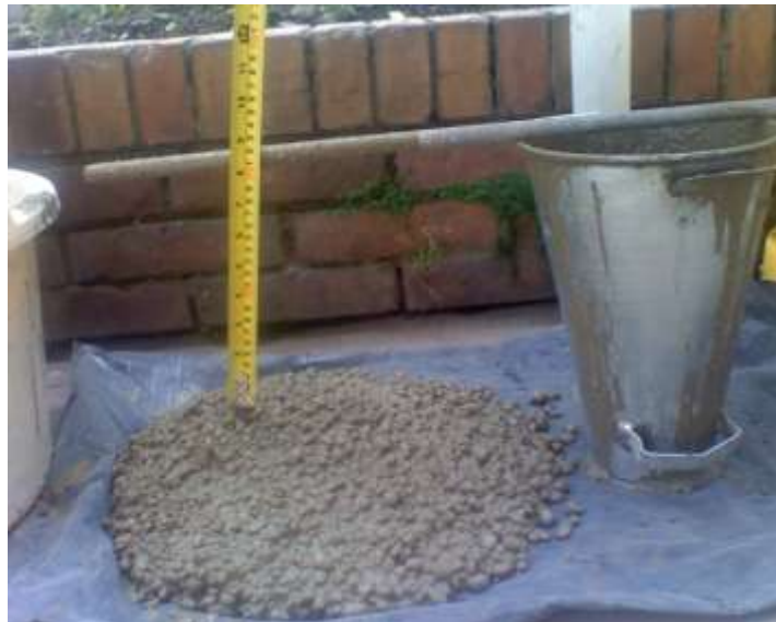
Figura D.6. Ensayo de asentamiento para Concreto Liviano de Alta Resistencia.
