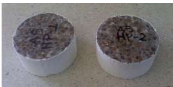
Figura C.1. Probetas impermeabilizadas lateralmente.
