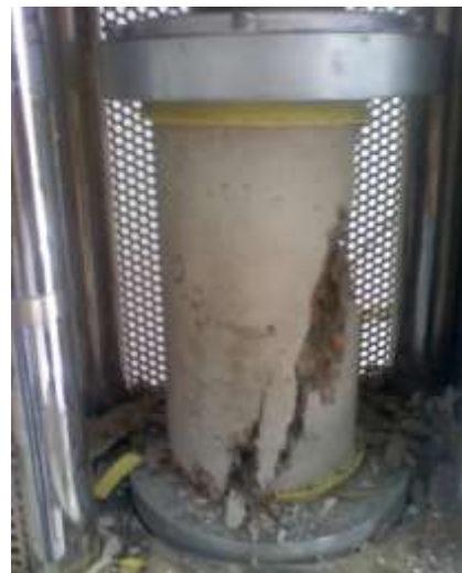
Figura 5.14. Falla típica a compresión de
