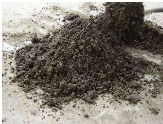
Figura 4.22. Estado final del concreto antes de ser colocado.
