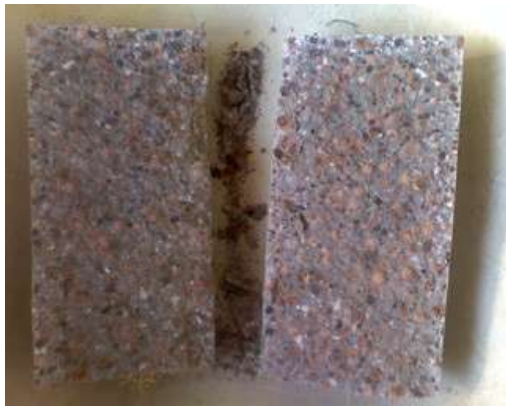
Figura 4.51. Superficie de falla de la probeta en el ensayo de Tracción indirecta.
