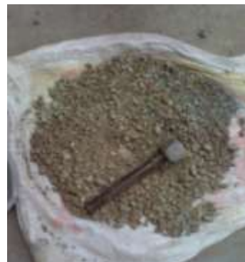
Figura 4.8. Trituración de arcilla de gran dureza por medio manual.
