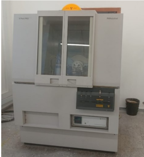
Figura 11- difractómetro Panalytical XPert Pro MPD del Departamento de Física de la Universidad Nacional de Colombia.
