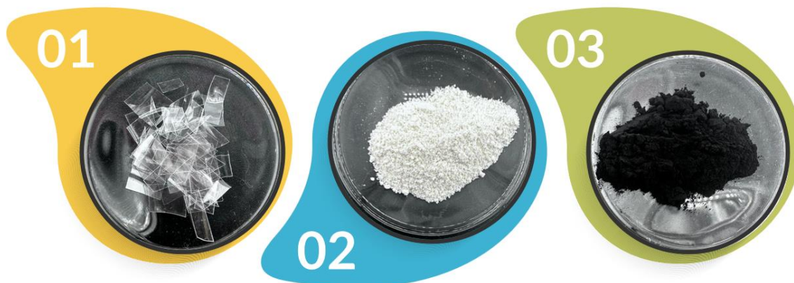
Figura 1. Registro fotográfico del proceso de síntesis de los carbones activados a partir de residuos PET. 1) Residuos PET cortados y lavados, 2) Polímero resultante de la degradación y activación de los residuos PET con KOH y 3) Carbón activado producto de la pirólisis del polímero resultante de la degradación y activación de los residuos PET con KOH.
