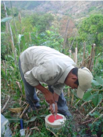
1. Muestreo de gases utilizado la técnica de la cámara cerrada
