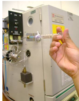
4. Inyección de muestra en cromatógrafo de gases
