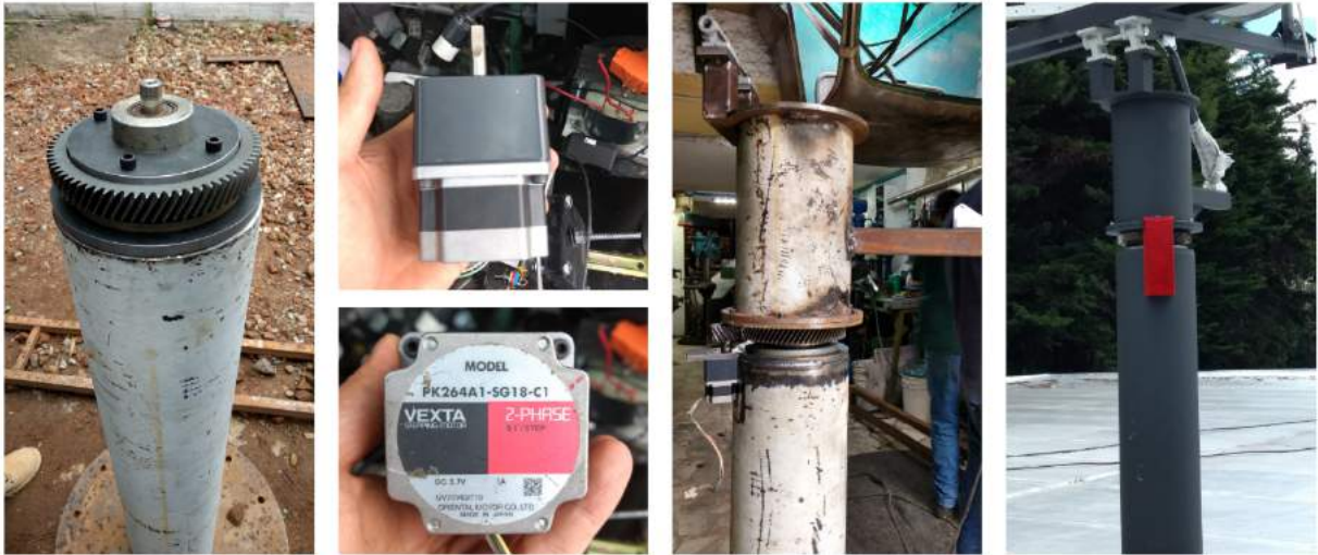
Figura 3-6.: Componentes del sistema de rotación en azimut.
