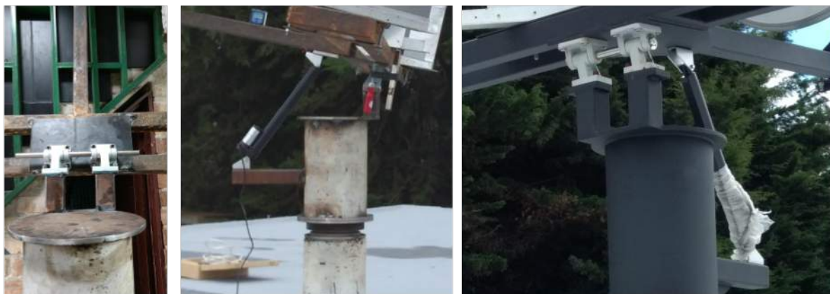
Figura 3-8.: Componentes del sistema de rotación en altura. Se observa el eje pivote, actuador lineal de tornillo y Ensamble.
