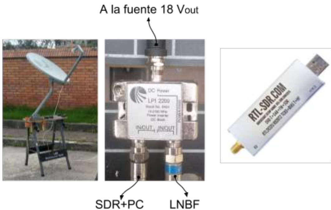
Figura C-1.: Elementos y conexión a SDR.
