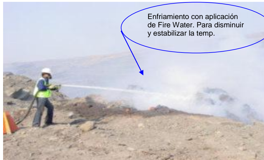
Ilustración 16. Incendio manto 55 aplicaciones de Fire Water.
