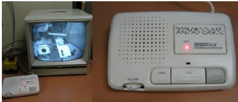
Figura 5.6 Circuito de televisión e intercomunicador [35].
