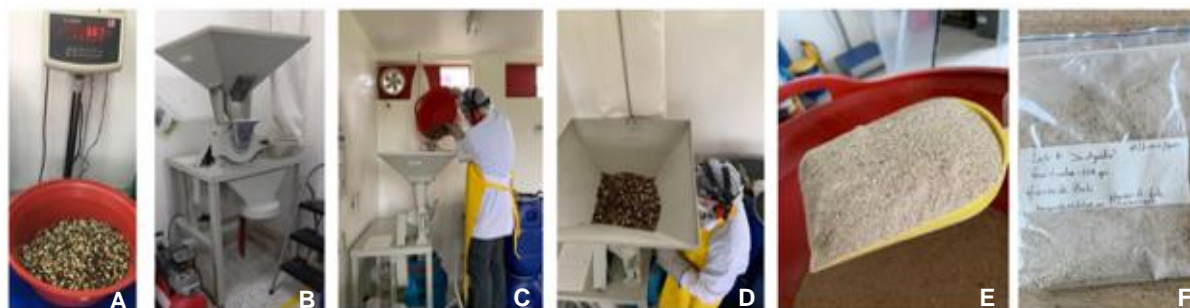
Figura 5. Secuencia de procesos para la obtención de harina de semillas de Erythrina edulis (balú). A. Pesaje de la semilla seca. B. Molino. C. Llenado de tolva del molino. D. Molienda. E. Harina de balú. F. Empaque e identificación del lote. Fuente: Vela H., 2021
