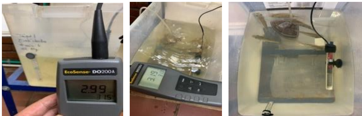
Figura 31. Parámetros físico químicos de los tanques de la prueba experimental. A. Oxímetros EcoSense DO200A – T^\circ 31,5^\circ\text{C} - OD: 2,99 mg/l. B. Oxímetros EcoSense DO200A – T^\circ 31,3^\circ\text{C} . C. Tanque con animales en reto infeccioso. Fuente: Vela H. 2022
