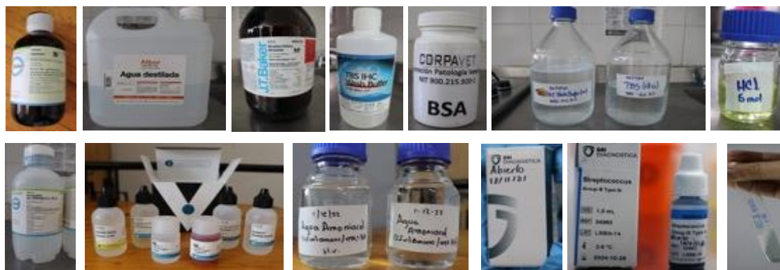
Figura 33. Reactivos usados en la prueba de inmunohistoquímica. A. Xilol. B. Agua destilada. C. Alcohol Etilico Absoluto. D. TBS IHC Wash Buffer. E. TBS (pH 7,6). F. Ácido clorhídrico (5 mol). G. Peróxido de Hidrógeno, 30%. H. Kit VECTASTAIN Elite ABC Universal — Peroxidase (Horse Anti-Mouse/Rabbit IgG). I. Agua Amoniacal J - K. Streptococcus Grupo B tipo Ib – SSI Diagnostica. K. GBS Ib. Fuente: Vela H. 2022.
