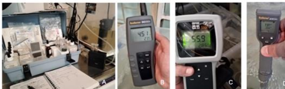
Figura 12. Equipos para toma de datos de parámetros físico – químicos del agua para las larvas de tilapia nilótica ( Oreochromis niloticus ) en bioasno. A. Kit FF1A. B. Oxímetro EcoSense DO200A (OD) YSI. C. Oxímetro 550A YSI (%). D. pH - metro EcoSense pH/EC1030 YSI. Fuente: Vela H. 2022
