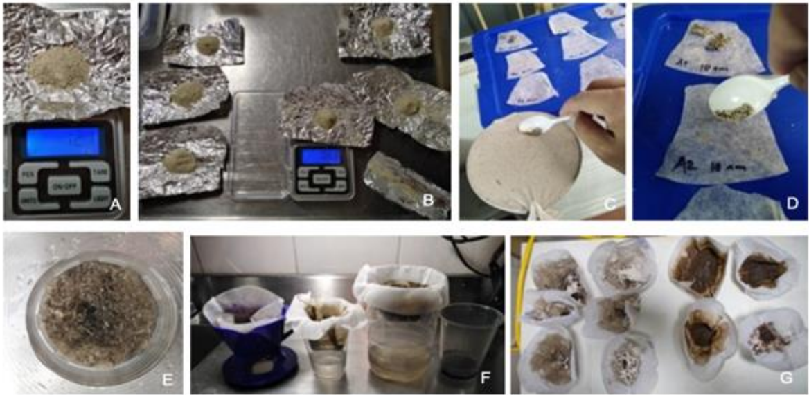
Figura 14. Pesaje de alimento a suministrar, alimento recuperado y alimento no consumido más heces suministro a tilapias nilóticas ( Oreochromis niloticus ). A - B. Pesaje raciones para cada tratamiento. C - D. Pesaje alimento recuperado. E. Heces y alimento no consumido recuperado. F. Alimento no consumido y heces en proceso de secado. G. Alimento no consumido y heces seco. Fuente: Vela H. 2022
