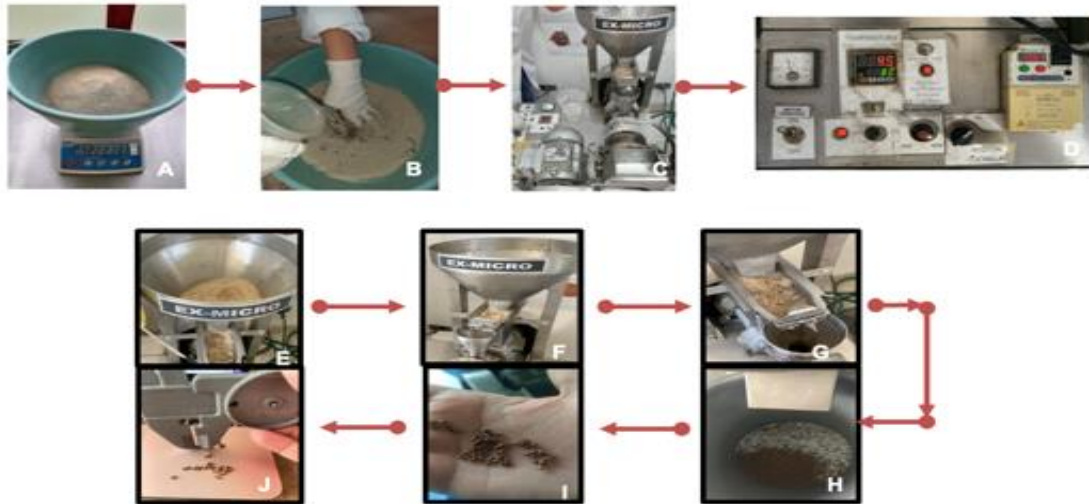
Figura 6. Proceso para la obtención de extruido a partir de harina de semillas de Erythrina edulis (balú) del lote V. A. Pesaje de harina. B. Hidratación C. Extrusora D. Estabilización de temperatura. E, F y G. Proceso de extrusión. H. Producto inicial extruido. I. Grano extruido de balú. J. Medida de los pellets extruidos. Fuente: Vela, H. 2022.
