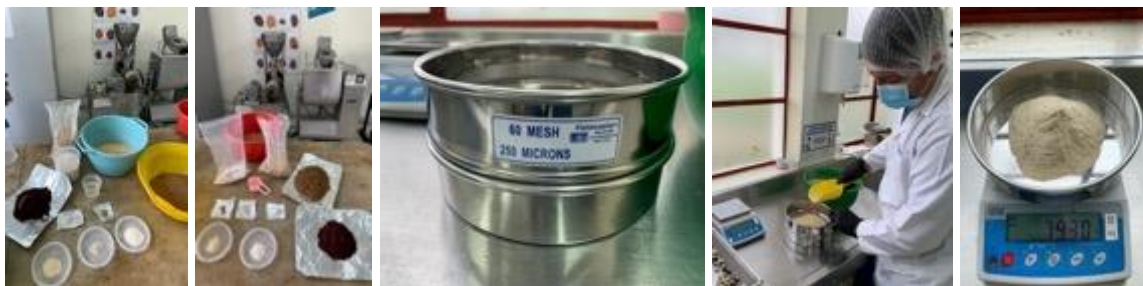
Figura 29. Procesamiento de materias primas para preparar dietas experimentales para el roto. A. Materia prima molida. B. Materia prima molida y pesada. C. Tamiz 250 micrones. D. Tamizaje de materia prima. E. Pesaje en balanza RADWAG WPT. Fuente: Vela H. 2022
