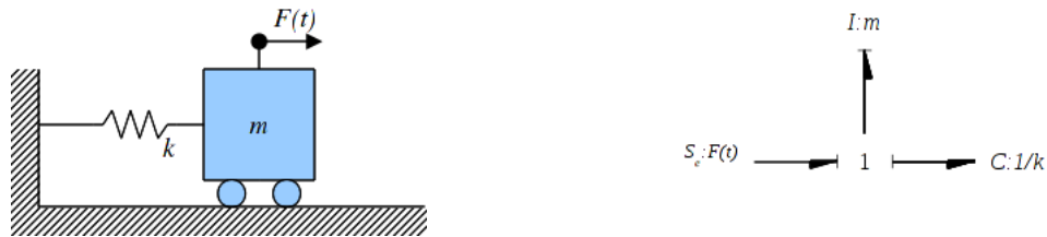
Figura 2-2: Sistema masa-resorte forzado: Sistema masa-resorte forzado, Gráfico de unión del sistema
