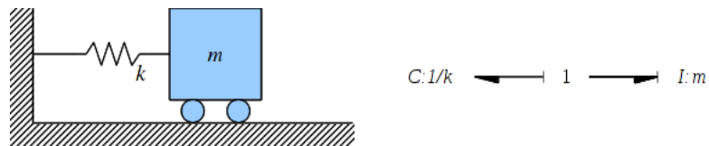
Figura 2-1: Sistema masa-resorte no forzado: Representación gráfica. Gráfico de unión.
