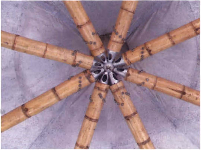
Figura 43. Prototipo de unión desarrollado por Obermann & Laude (2004) Foto. Eugenia González C. 2009
