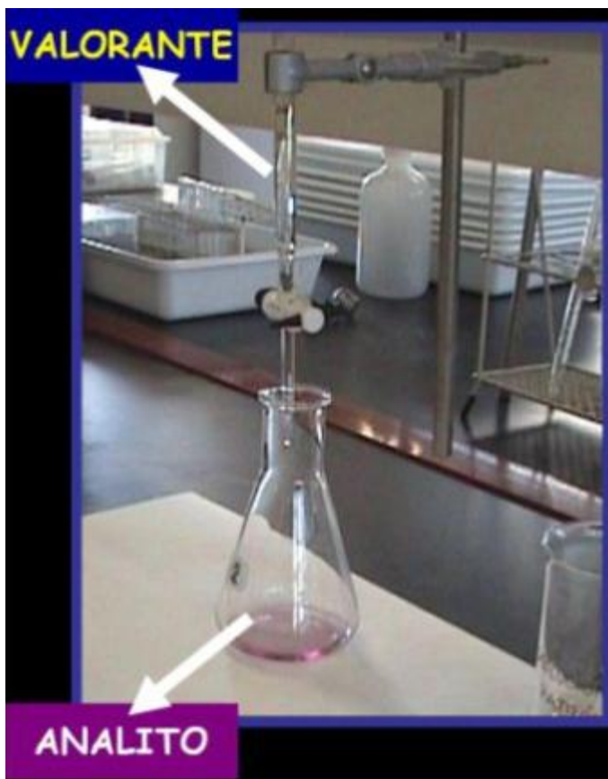
Figura 2- 5 Montaje de titulación, tomado de (Universidad de Valencia, 2015)
