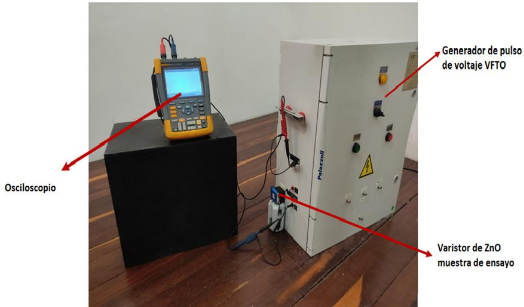
Figura 4-1: Circuito de prueba para determinar la tensión virtual y la corriente de descarga que circula por los terminales de los cinco varistores de referencia B40K150.
