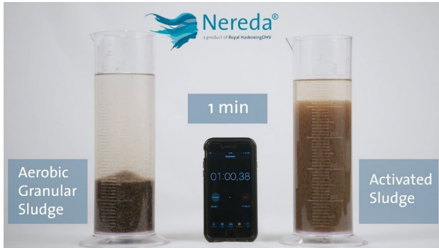
Figura 20 Tecnología Nereda® Fuente: (Nerada, 2019)
