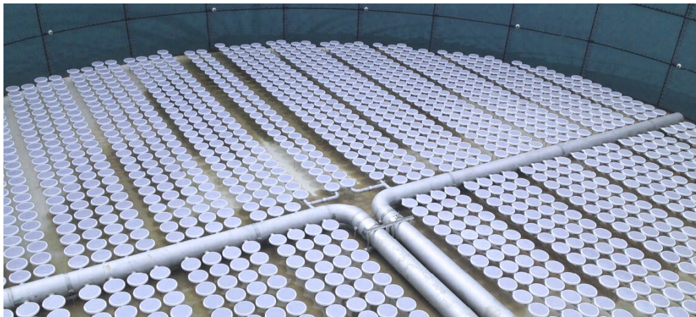
Figura 25 Sistema de inyección de aire - Reactor de Lodos Activados
