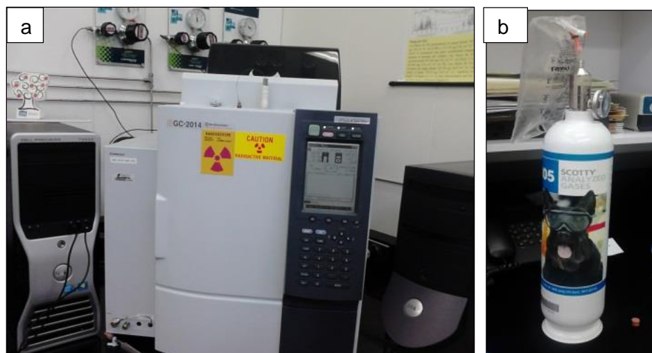
Figura 2-1: Cromatógrafo de gases GC-2014 (a), estándar certificado (b)
