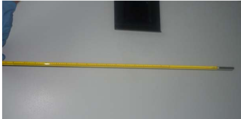
Figura 3.2. Termómetro ASTM 56C-86 usado en la experimentación [El Autor]
