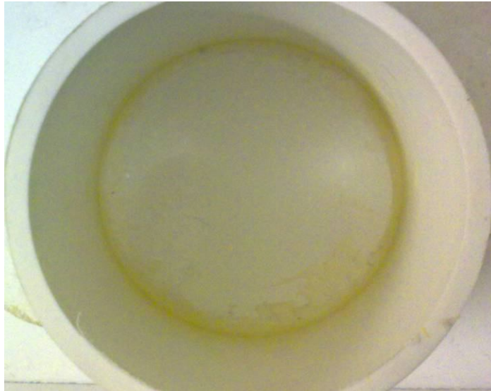
Figura 36. Fotografía Primer Epoxi-zinc/Acabado Polisiloxano 4500 horas en inmersión NaCl
