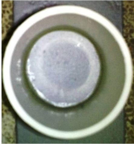
Figura 71. Fotografía Primer Mastic epóxico de aluminio 4500 horas en inmersión \text{Na}_2\text{SO}_4
