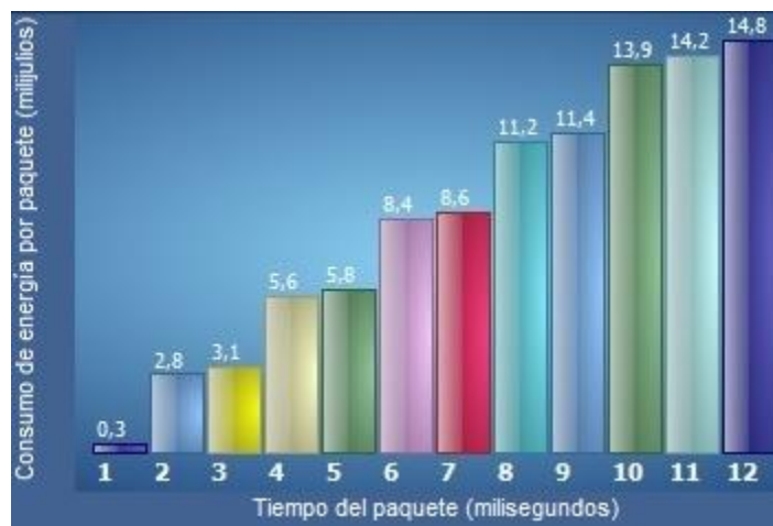
Figura 4-4: Consumo incrementando el tiempo de duración del paquete, ecuación 1.13.
