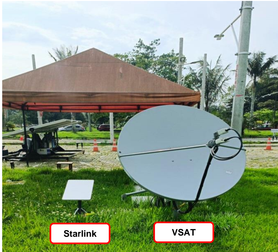
Figura 25. Comparación antenas Starlink vs VSAT.
