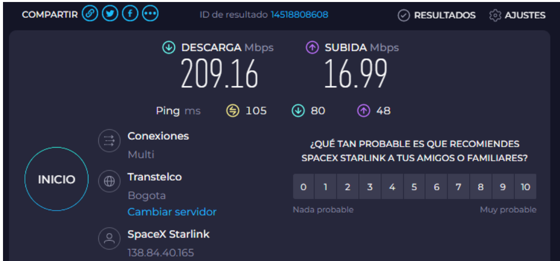
Figura 27. Velocidad de descarga, velocidad de subida y latencia del sistema Starlink.
