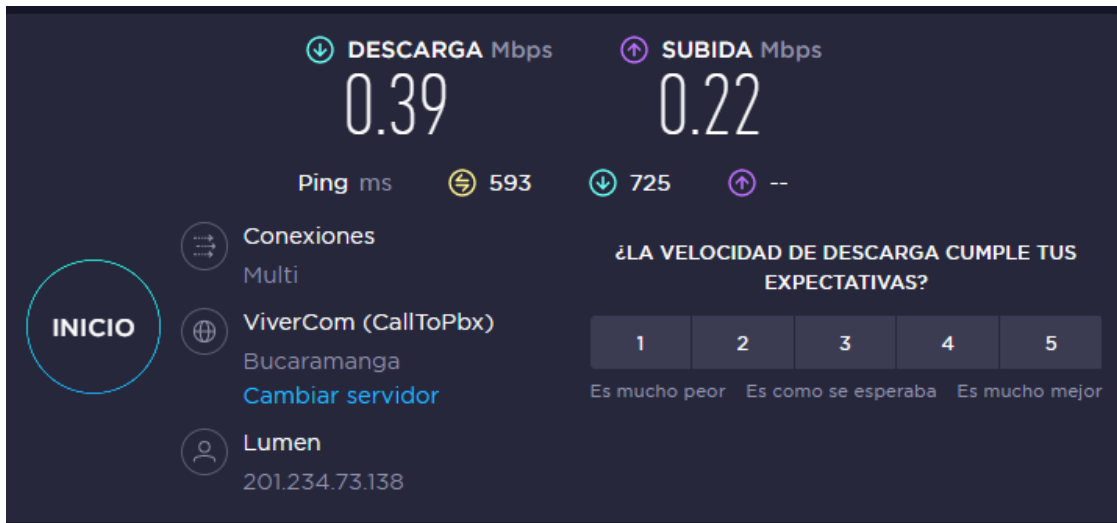
Figura 26. Velocidad de descarga, velocidad de subida y latencia del sistema VSAT.
