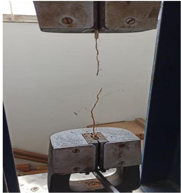
Figura 14. Ensayo de tensión en Raíz
