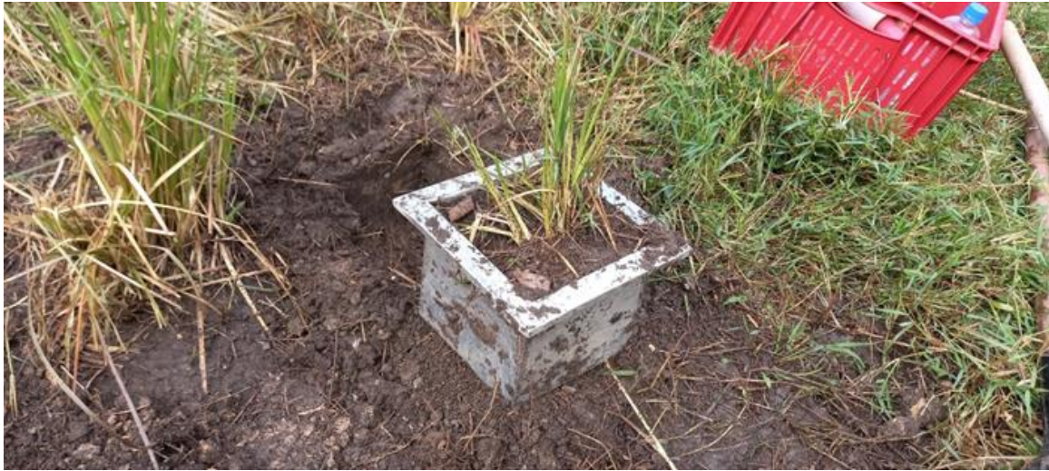
Figura 12. Extracción de muestra en terreno
