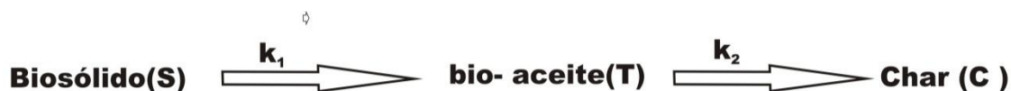
Figura 1- 4. Modelo en serie del tipo global para la pirólisis de biosólido propuesto por Othman et al. [31].
