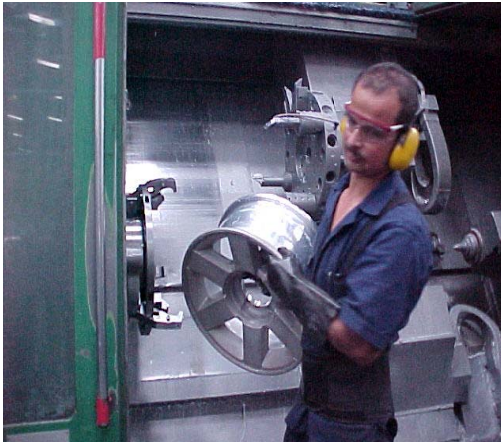
Figura. 7 Mecanizado del rin en el torno Leadwell.
