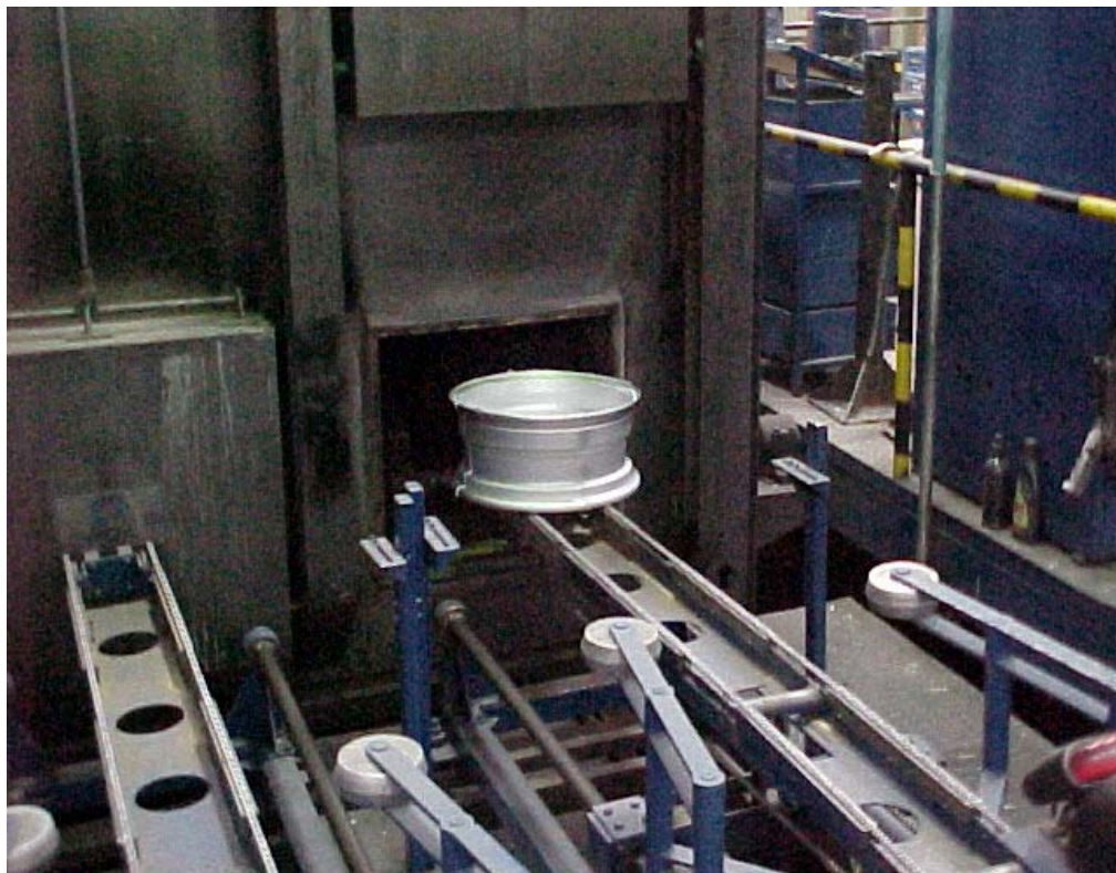
Figura. 4 Entrada del rin al horno de solubilización.
