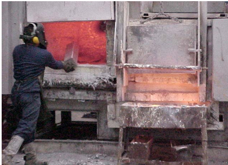
Figura. 2 Fundición de lingotes de aluminio por combustión directa.
