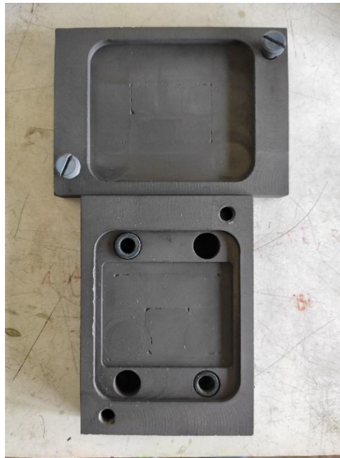
Figura 2-2: Fotografía del portasustrato y crisoles de grafito fabricados (vista superior).
