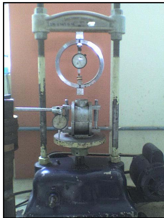
Foto 2. Aparato Marshall para prueba de estabilidad y flujo. Foto de autor
