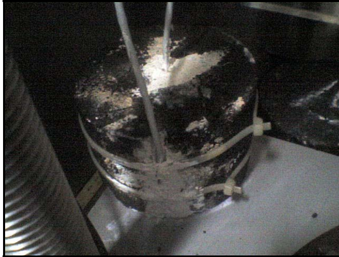
Foto 2. Briqueta de control de temperatura. Foto de autor
