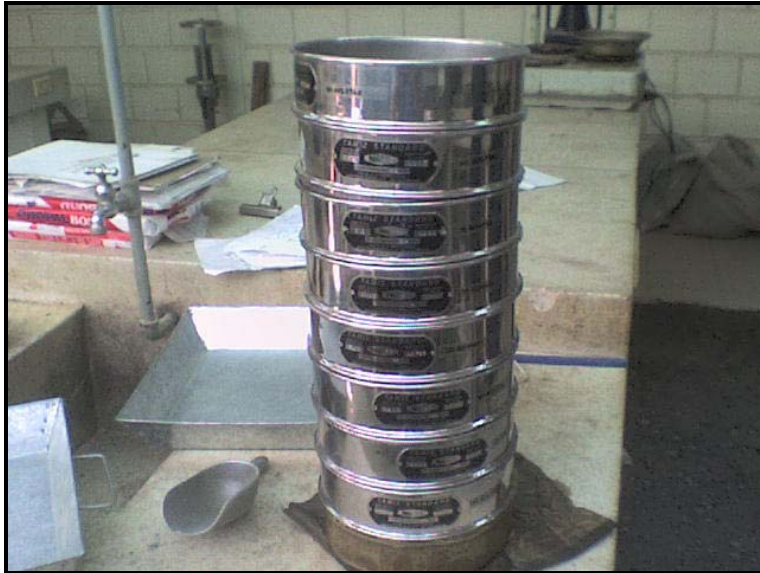
Foto 3. Tamices para la realización del análisis granulométrico. Foto de autor
