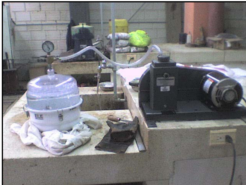
Foto 6. Extracción del aire de la muestra en el ensayo RICE. Foto de autor
