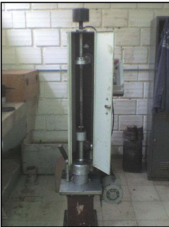
Foto 1. Martillo mecánico para compactación de briquetas Marshall. Foto de autor
