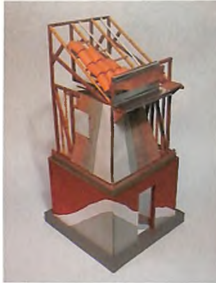
Figura 1.25. Mampostería de ladrillo 1º piso y Bahareque 2º piso.
