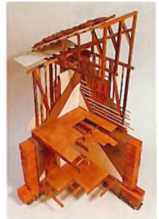
Figura 1.13. Estilo Temblorero 3 1° PISO: Mampostería De Ladrillo 2° PISO: Bahareque de tierra
