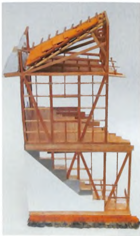
Figura 1.93. Marcos estructurales en madera
