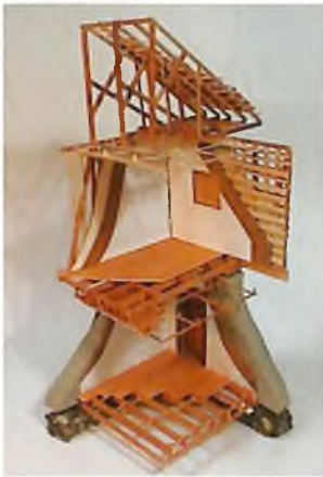
Figura 1.11. Estilo Temblorero 1 1° PISO: Tapias de tierra pisada 2° PISO: Bahareque de tierra
