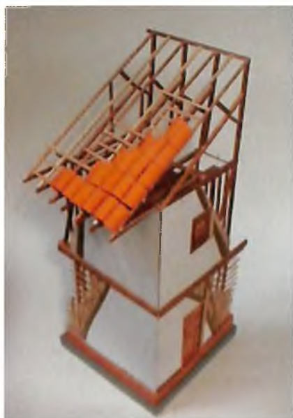
Figura 1.59. Marcos estructurales en madera
