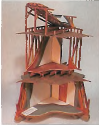
Figura 1.21. Pórticos en concreto – Bahareque 1º y 2º piso.
