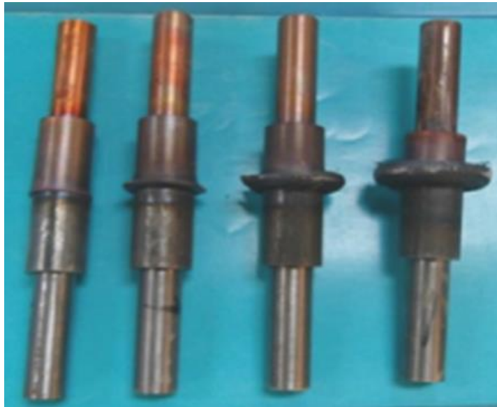
a) Juntas experimentales de soldadura, tomada de [90].
