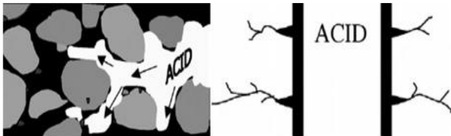
Figura 7. Acidificación matricial en areniscas y agujeros de gusano en carbonatos. Tomado de (5)
