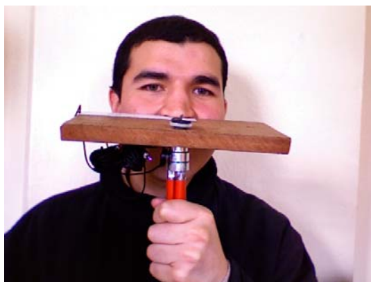
Fig. 6. Nasómetro diseñado y desarrollado en el Laboratorio de Lingüística
