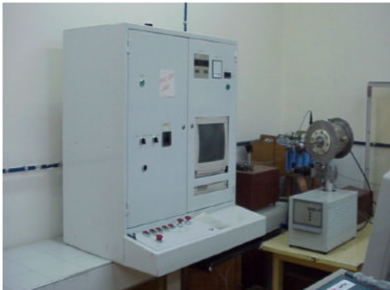
Figura 3.1. Fotografía del equipo utilizado en la deposición de recubrimientos duros por PAPVD.
