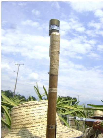
Figura 4-12. Dispositivo del Sensor 1 o Canal 1 LI 190SA para medir la radiación externa (Foto J.A. Medina S)
