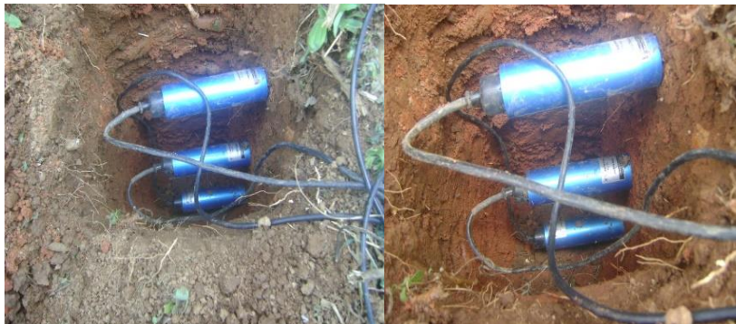
Figura 5-46. Sensores para medir la velocidad del movimiento del flujo de savia (SAP FLOW), ubicados en Restrepo y Riofrío (Fotos: Jorge A. Medina S.)
