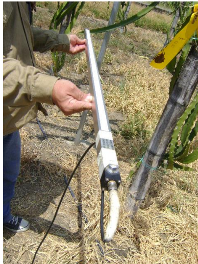
Figura 4-13. Barra cuántica Sensor lineal LI-191SA con la que se midió la radiación en el interior de la planta (Foto J.A. Medina S)
