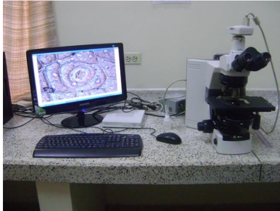
Figura 4-15. Microscopio de luz Nikon Eclipse 80i. En el monitor esta la imagen del estoma que se está midiendo (Foto J.A. Medina S)
