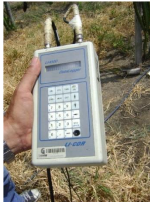
Figura 4-11. Equipo Data Logger Li-COR LI-1000, empleado para estimar la radiación solar (Foto J.A. Medina S)
