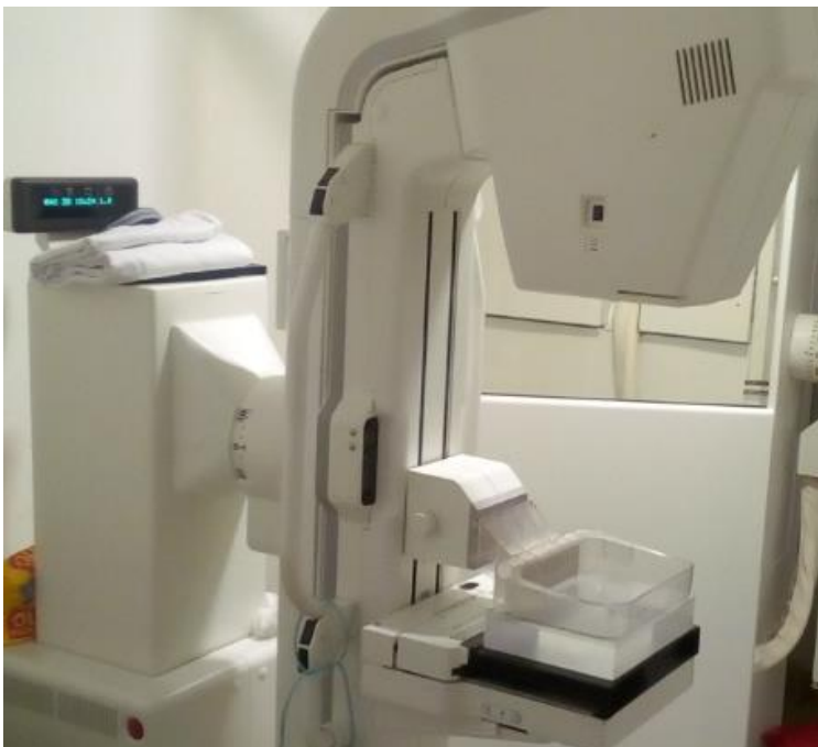
Figura 29. Posicionamiento de PMMA para exactitud del espesor
