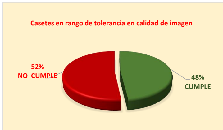
Figura 61. Resultado de la puntuación de los casetes CR del piloto de este trabajo para evaluación de calidad de imagen con el maniquí de la ACR.
