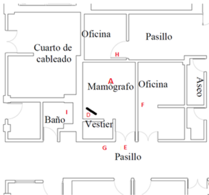
Figure 67: Ejemplo de plano arquitectónico de apoyo para radiometría de un servicio de mamografía. Fuente: Resultados de la prueba piloto
