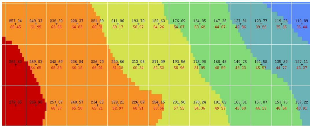
Figura 22 Estimación de Oro con el método de bandas rotantes (media de la estimación) para el bloque A2
