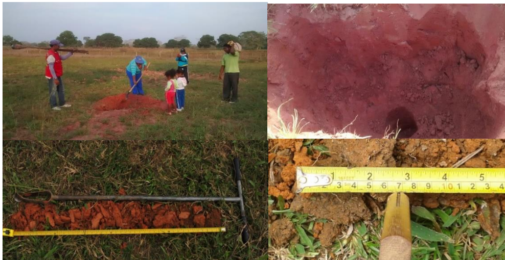
Figura 4-2: Muestreo de suelos mediante calicatas o cajuelas y barrenadas.
