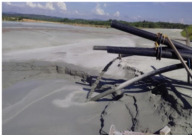
Figura 5-17: piscina de residuos industriales de la molienda de la roca en minería aurífera subterránea
