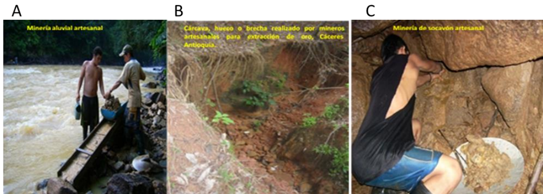
Figura 5-1: Técnica de extracción de oro en el Bajo Cauca Antioqueño en la minería artesanal. A. Equipo artesanal de extracción de oro aluvial, compuesto por zaranda y canoa. B. Cárcava para explorar minería coluvial. C. Barequero extrayendo manualmente material entre rocas.
