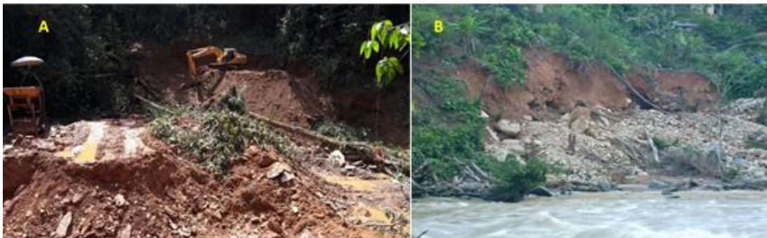
Figura 5-4: Remoción de material y extracción de oro coluvio-aluvial; A: Maquinaria removiendo material; B: Trabajadero por minería artesanal.
