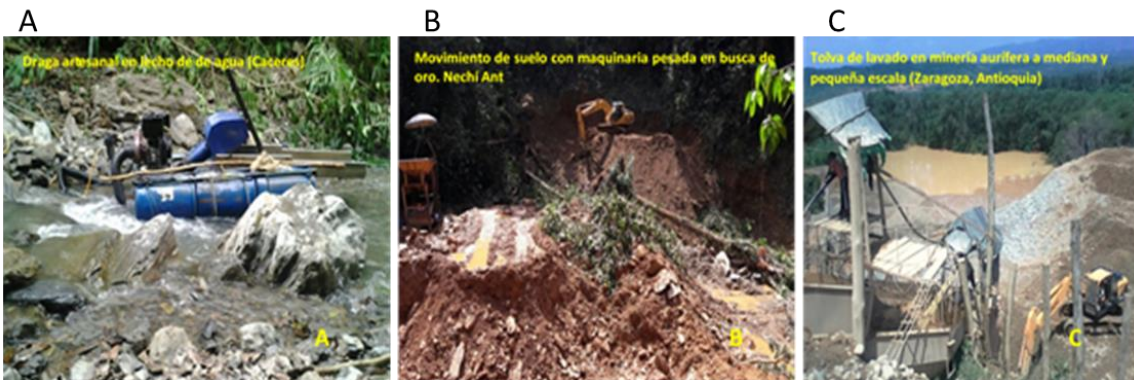
Figura 5-3: Minería a pequeña y mediana escala de tipo aluvial y coluvial realizada en la subregión del Bajo Cauca Antioqueño. A. Pequeña minería aluvial; B. Pequeña minería coluvial; C. Tolvas mecanizadas para facilitar la precipitación del oro por gravedad.
