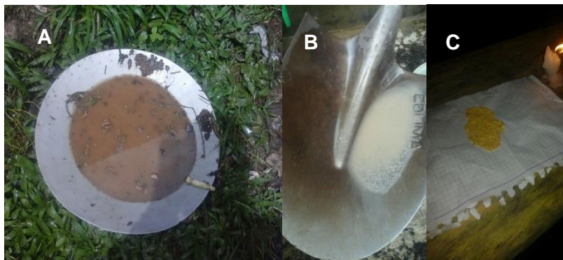
Figura 5-7: herramientas simples de uso común en minería artesanal y pequeña minería. A. Batea empleada para extracción de oro en minería artesanal; B. Pala empleada para minería artesanal; C. Polvo de oro extraído por minería artesanal
