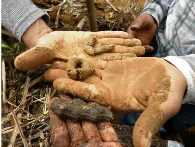
Figura 4-5: Determinación de textura del suelo al tacto.
