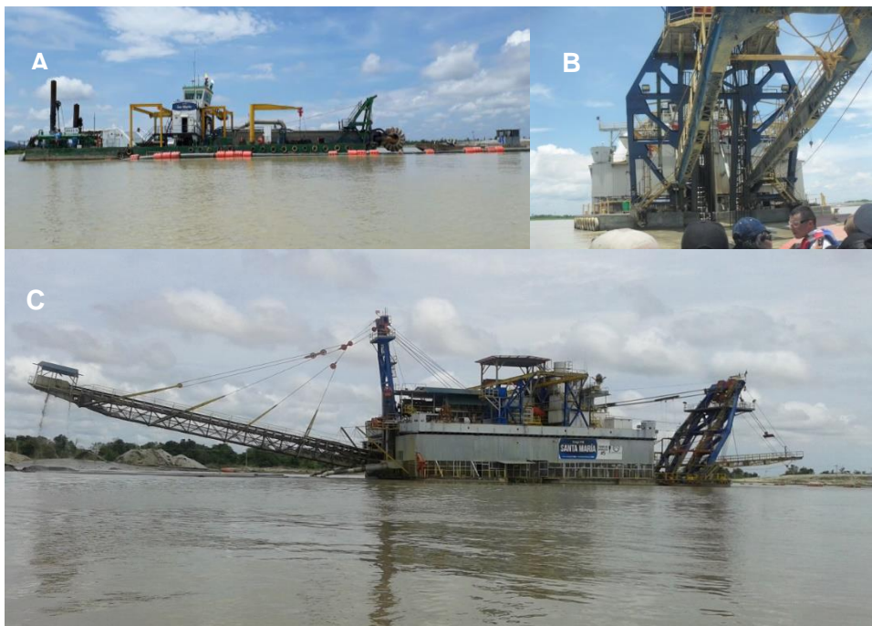
Figura 5-18: Equipos de dragado de alto grado tecnológico, en minería aluvial a cielo abierto. A. Dragón para romper suelo y eliminar material vegetal del suelo; B. Brazo de draga industrial; C. Draga industrial de cucharas para extracción aurífera aluvial a profundidad.
