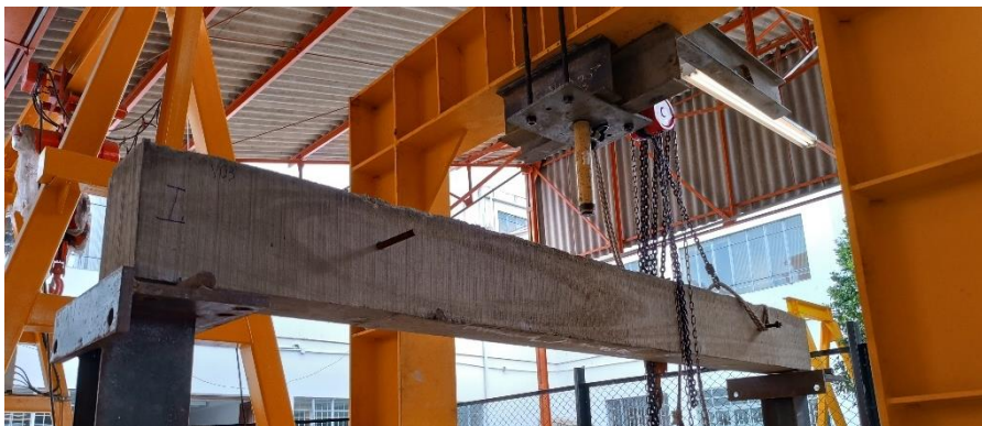
Figura 4-6: Montaje de ensayo a 4 puntos
