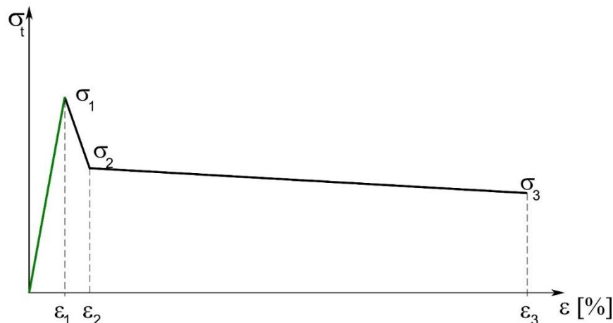
Figura 3-16: Esquema del modelo constitutivo trilineal a tracción del SFRC.
