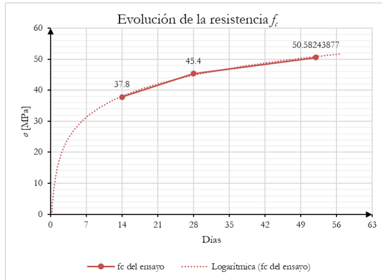
Figura 3-3: Gráfica experimental de la resistencia a compresión de la mezcla de concreto sin fibras
