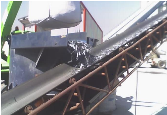
Figura 1-1 : Dosificación de fibras con maquinaria
