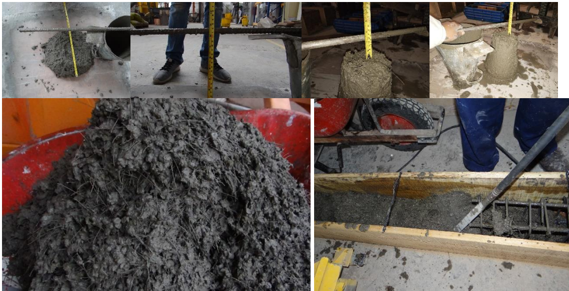
Figura 4-1: Mezcla de concreto y concreto SFRC. Fotografías en estado fresco, asentamiento y mezclado
