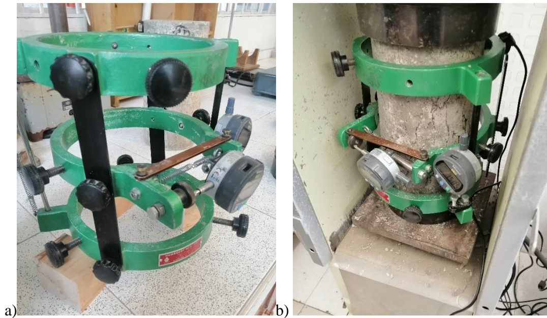
Figura 3-4: Instrumentación según NTC 4025 a) compresómetros - anillos b) probeta ensayada con los anillos hasta el final del ensayo c) Detalle de especificaciones de los comparadores de caratula digital d) imagen de instrumentación tomada de la NTC4025
