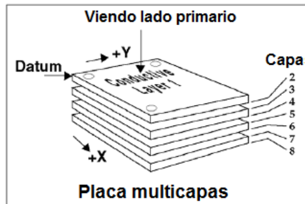
Figura 2-18: Enumeración de las capas [IPC-D-350]
