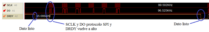
Figura 4-28: Señal SPI del ADC con banderas de control para transmisión sincronizada de datos.
