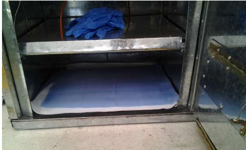
Fotografía 2 - 10. Primera, segunda y tercera capa, material sangrador y material desmoldante.
