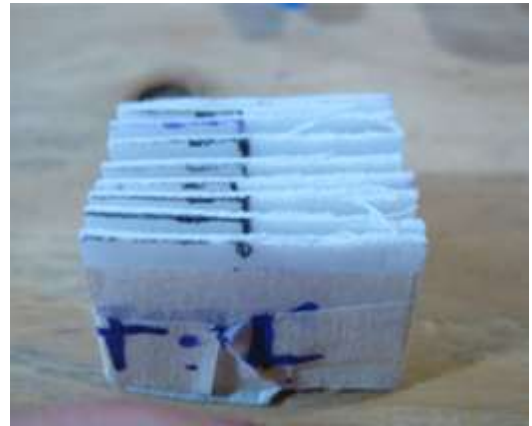
Probetas 10 a 18 Tenacidad de fractura translaminar
