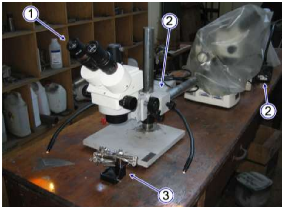
1. Estereoscopio 2. Fuentes de luz 3. Soporte para probetas
