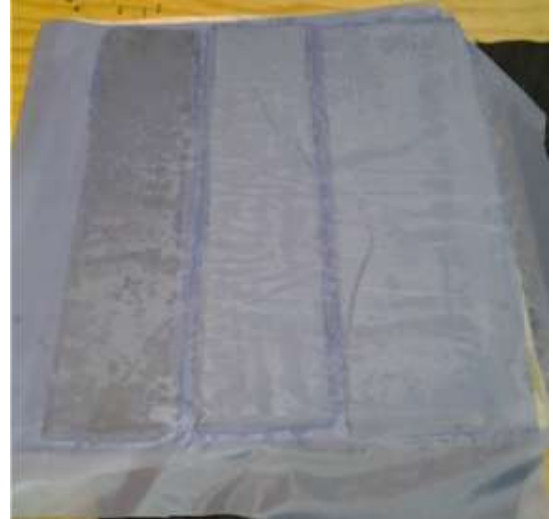
Piezas con tela desmoldante.
