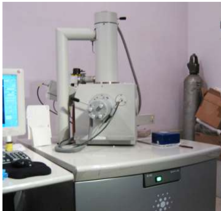
Fotografía 2 - 12. E-SEM utilizado para la toma de las imágenes.
