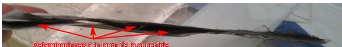
Gráfico 3 - 4. Vista lateral de una pieza fabricada con una relación de 0.5:1 entre la matriz y el material de refuerzo
