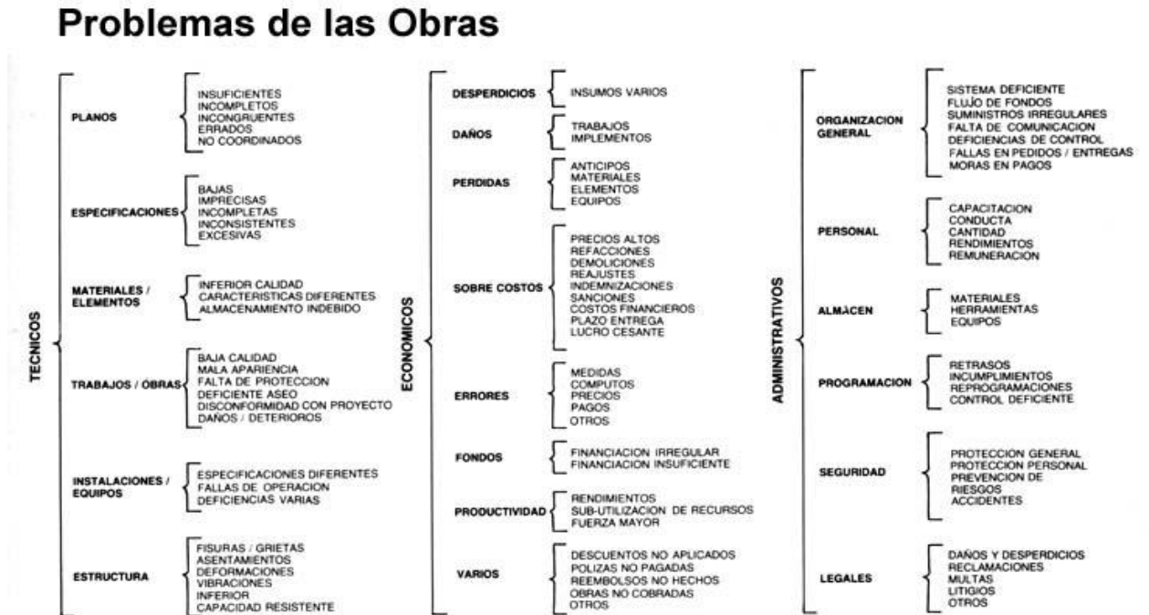
Ilustración 2. Problemas de las obras de construcción.
